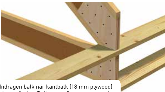
D25 Ändupplag takbalk och bjälklagsbalk
