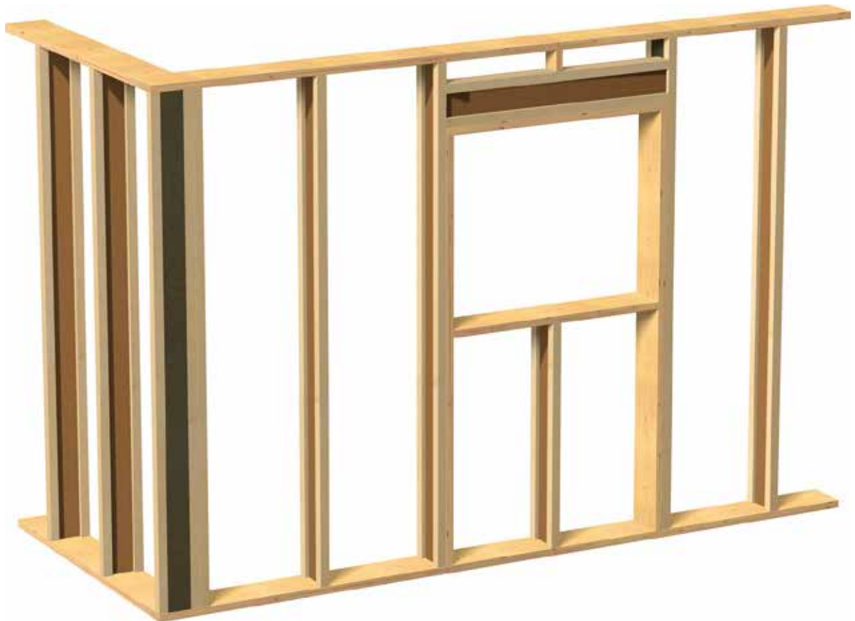
Principskiss väggelement med Hunton Lättbalk.
