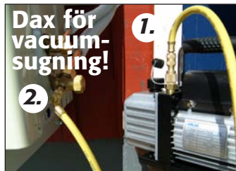
31. Vakuumsugning utan manometerställ. 1. Anslut slangen till vacuum-pumpen. 2. Anslut slangen till sugarröret.
