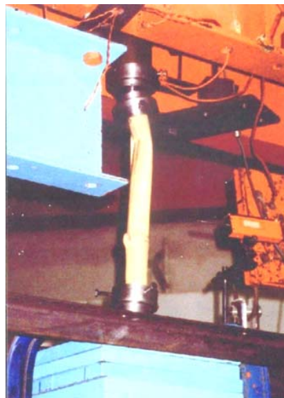
b) Local buckling
