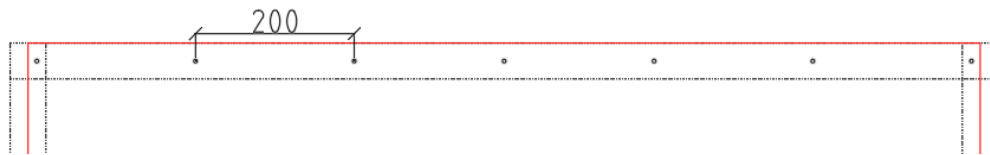
Figur 32: Illustration av antal skruvar i skivans överkant, samt deras centrumavstånd.
