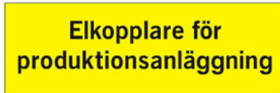
Bild 19. Exempel på skylt som utmärker elkopplare för produktionsanläggning.
