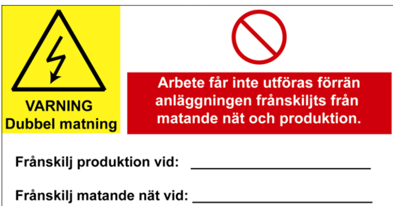
Bild 20. Exempel på skylt som varnar för bakspänning, används när elkopplaren inte sitter i mätarskåpet. Används främst vid strömtrafomätta anläggningar,
