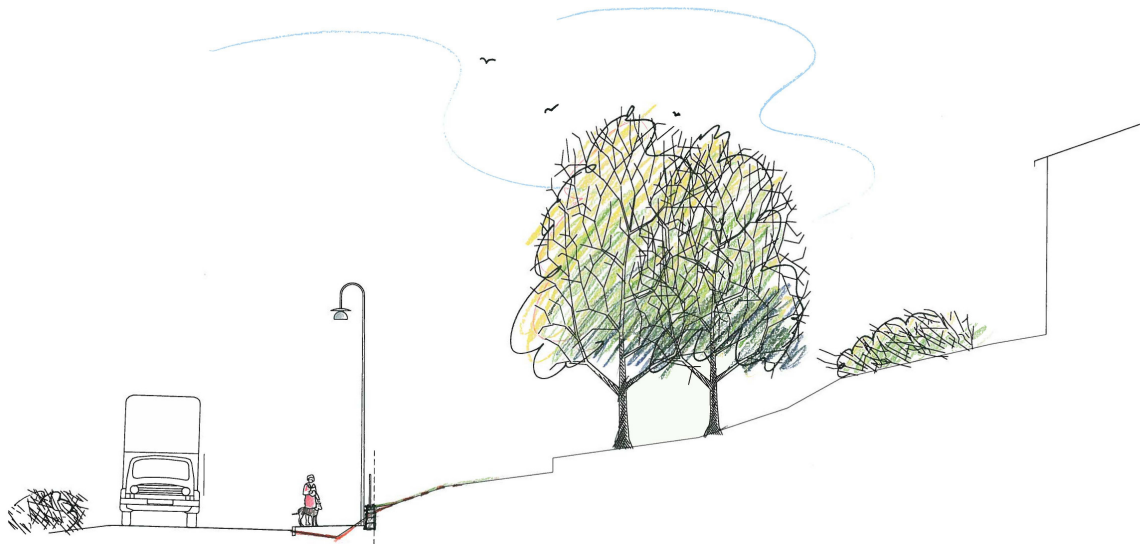
Illustrationen visar förslag till gestaltning av Runsavägen, med stödmur vid anslutning till bebyggda tomter. (Illustration: Bjerking)
