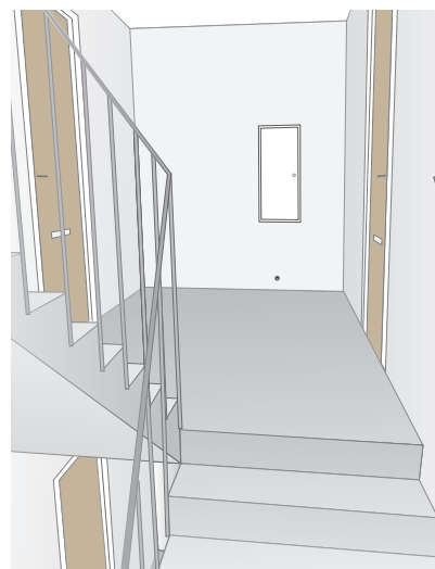
U4.1.5a Undantag i trapphus med vattenavvisande golv.
